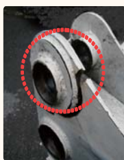
プレートのピンボス周りの亀裂
