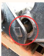
プレート連結ボス部の異常摩耗
